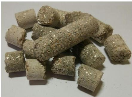
Рисунок 6.6 – Композитный сорбент
