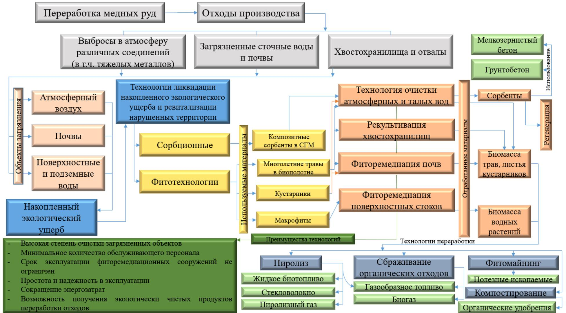
Рисунок 6.16 – Комплексная технологическая схема ликвидации накопленного ущерба
