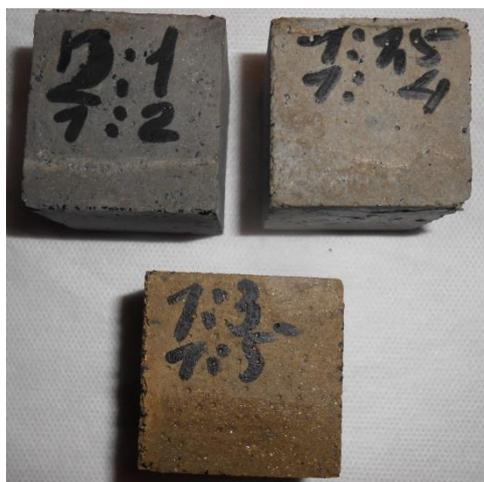
Рисунок 2.9 – Оценка степени капиллярного подсоса полученными композитами Ш:Г+Ц [383]
